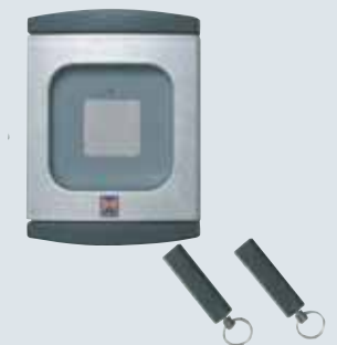
Transpondery TTR 100, TTR 1000 Wygodny sposób otwierania bramy: wystarczy przytrzymać klucz transpondera, zawierający Twój osobisty kod, w odległości ok. 2 cm przed czytnikiem. Bez dotykowo! Takie rozwiązanie jest szczególnie przydatne w ciemności. Przeznaczony na maks. 100 (TTR 100) lub 1000 kluczy do transpondera (TTR 1000). W komplecie dostarczamy dwa klucze do transpondera.
