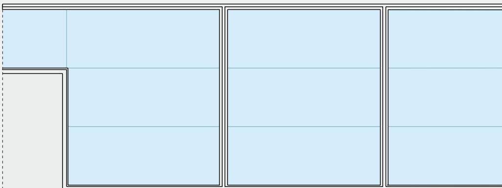
Ściana systemowa ze spoiną poprzeczną w przeszkleeniu i wycięciem (przykład) Możliwe także skosy (dotyczy tylko wykonania ze stali S-Line i N-Line).
