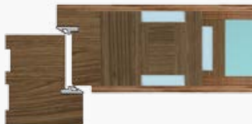
Przekrój drzwi gr. 82 mm z profilem kompozytowym
