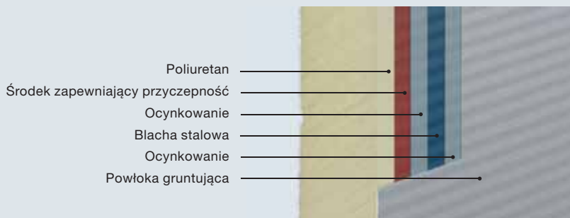
Budowa płyty bramy
