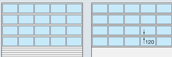
W bramach z powierzchnią w strukturze Micrograin i Stucco wysokość cokołu wynosi standardowo 750 mm, opcjonalnie 500 mm, 1000 mm i 1500 mm
