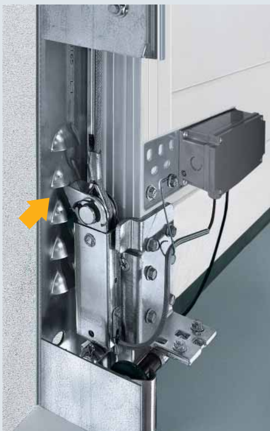
Zatrask ryglujący w kształcie haka blokuje się automatycznie przy próbie podważenia bramy.
