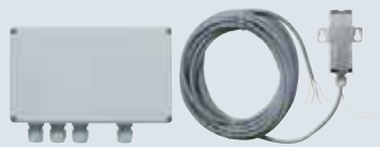
2-zakresowy odbiornik przekaźnikowy HER 2 Z 2 bezpotencjałowymi wyjściami przekaźnikowymi, częstotliwość 868 MHz, IP 65, napięcie robocze 24 V DC / 230-240 V AC, oddzielna antena zewnętrzna (IP 65), w aluminiowej budowie zabezpieczonej przed sabotażem, 3-żyłowy przewód przyłączeniowy 7 m, jednostka analizująca do montażu wewnątrz
