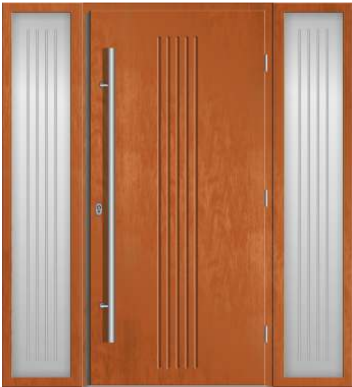
Model: DIPLOMAT ON Doświetla boczne: wariant II Kolor: RAL 8023 Powierzchnia skrzydła: RW Zwrót otwierania: prawy na zewnątrz Zamek: listwowy 3-punktowy ryglowany wkładką - wykonanie opcjonalne Zawiasy: regulowane 3D w kolorze okuć Witraż: projekt indywidualny Wariant aplikacji: F Okucia: pochwył P45 / klamka Lord / rozetka (F9)
