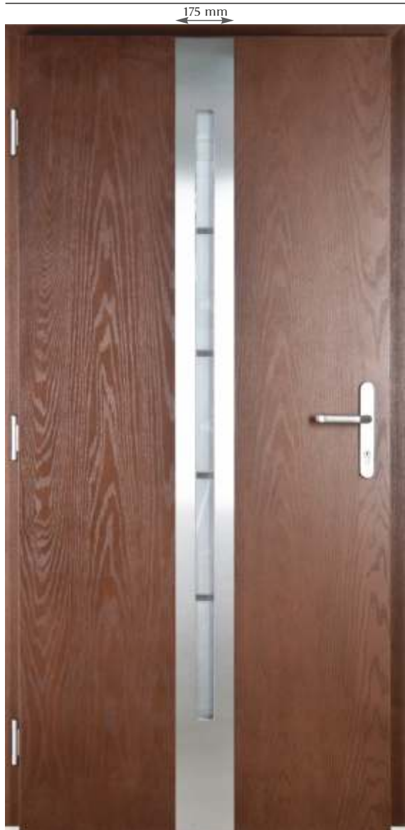
Model: DIPLMAT 4M Kolor: Orzech Powierzchnia skrzydła: RW Witraż: 3.1-128-D/T/D Zwrot otwierania: lewy na zewnątrz Zamek: listwowy 3-punktowy ryglowany klamką Zawiasy: regulowane 3D w kolorze okuć Wariant aplikacji: RN Okucia: klamka Baron (F9)
